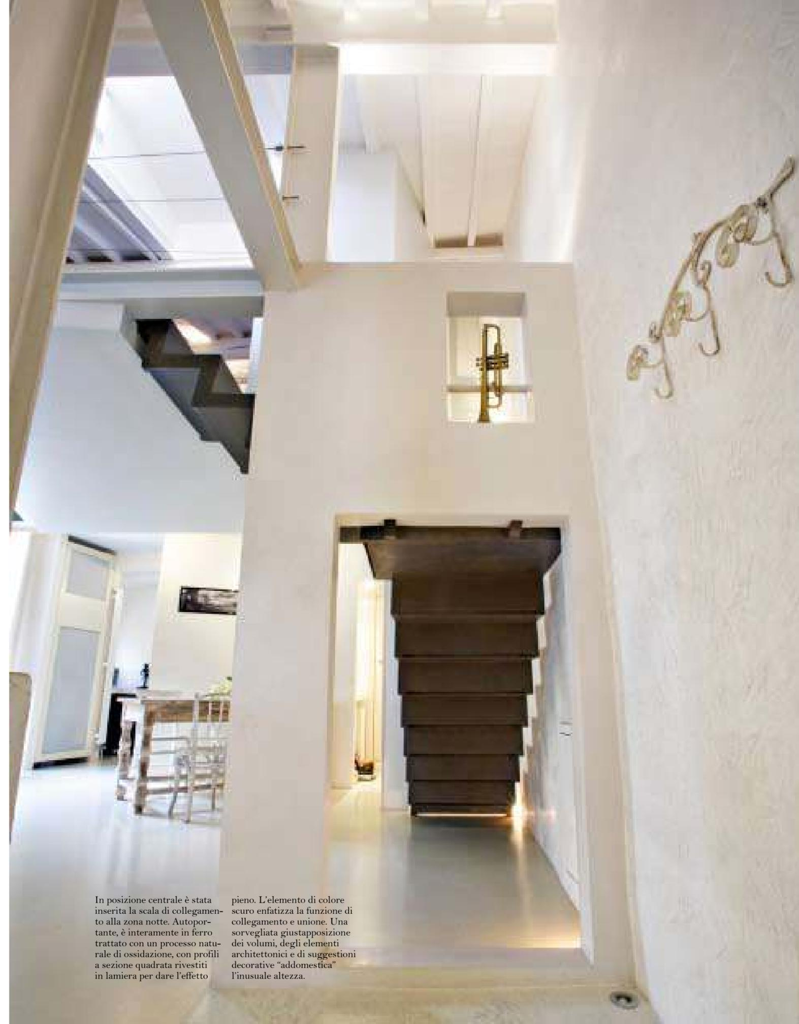
In posizione centrale è stata inserita la scala di collegamento alla zona notte. Autoportante, è interamente in ferro trattato con un processo naturale di ossidazione, con profili a sezione quadrata rivestiti in lamiera per dare l'effetto
